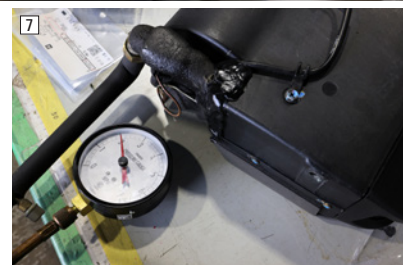
⑤ EF64 1046号機に搭載されるクーラーを室内側からみる。画面奥が冷風吹き出し口。⑥ 機のうえに整備された本体を置いて試験中。画面左の窒素ガスを送り込んで行われていた。⑦ 窒素ガスから本体へ送り込まれる圧力は2MPa。
