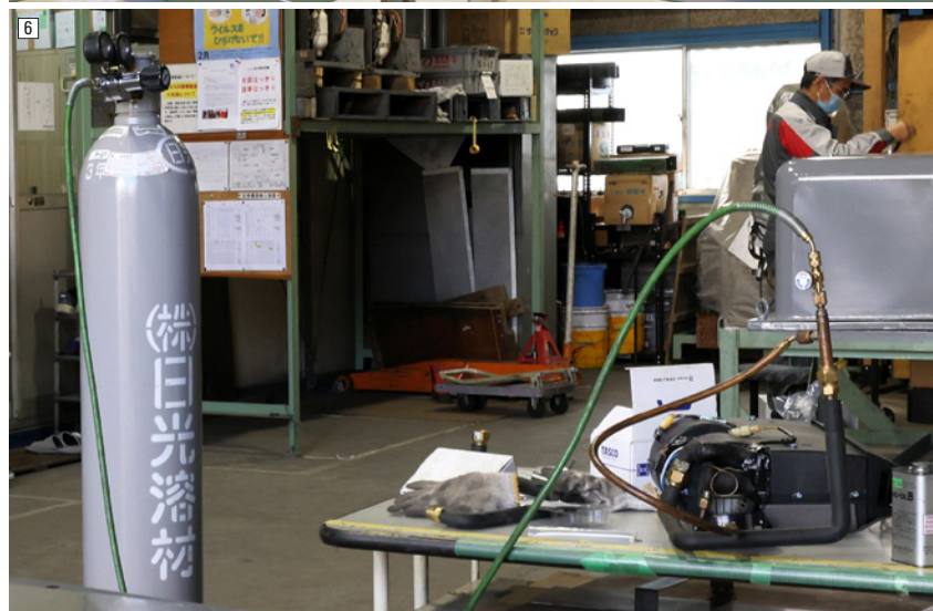
⑤ EF64 1046号機に搭載されるクーラーを室内側からみる。画面奥が冷風吹き出し口。⑥ 機のうえに整備された本体を置いて試験中。画面左の窒素ガスを送り込んで行われていた。⑦ 窒素ガスから本体へ送り込まれる圧力は2MPa。
